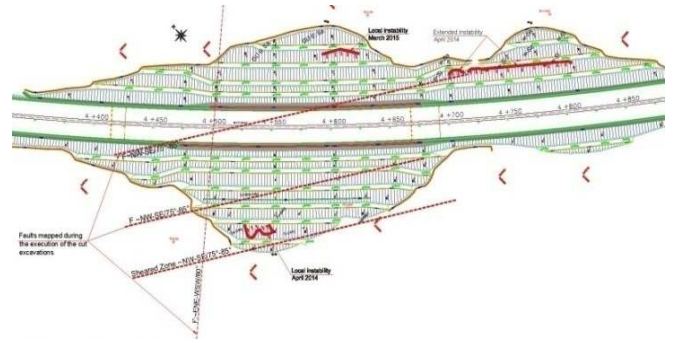
Αστοχίες και ζώνες ρηγμάτων και διάτμησης κατά μήκος του ορύγματος Mullet, καθώς αποκαλύφθηκαν κατά τη διάρκεια της κατασκευής
